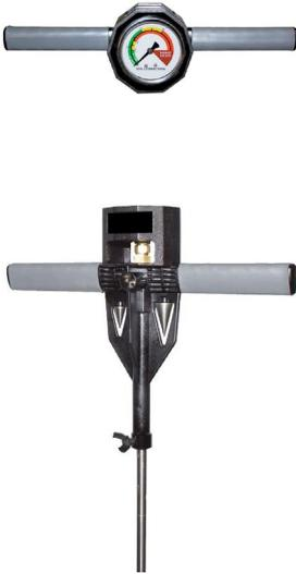
Плотномер поставляется в комплекте с двумя наконечниками: диаметром 1,27 см для проведения измерений плотности в твердом грунте и диаметром 1,91 см для проведения измерений плотности в мягком грунте. Удобное крепление наконечников на корпусе прибора обеспечивает надежную сохранность наконечников в период хранения.
