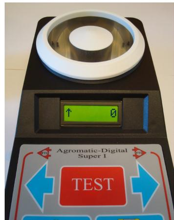
Закончив насыпать материал в измерительную камеру, на дисплее отобразятся числа от 98 до 102. Вы видите, что левая стрелка на дисплее сменилась на горизонтальную стрелку. Если вы насыпали слишком много измерительной пробы в камеру, стрелка будет показывать вниз – имеется в виду: слишком много тестирующего образца в камере.
