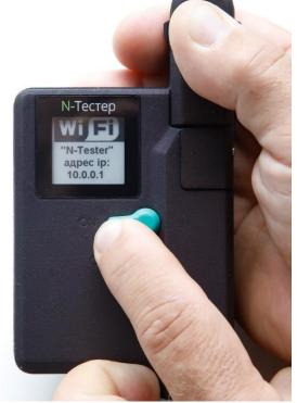
В этом режиме N-Тестер создаёт сеть Wi-Fi «N-Tester» посредством которой подключаемся к прибору.
