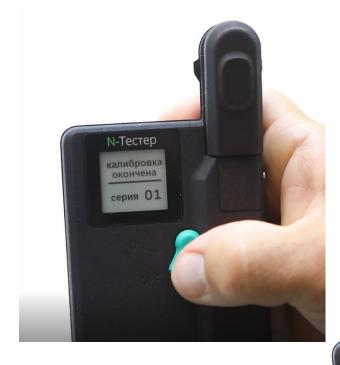
После включения в режиме измерений появляется надпись на экране «калибровка-нажать и удерживать до сигнала».
